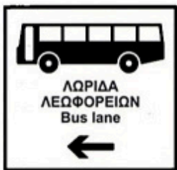
Προειδοποίηση ότι πλησιάζουμε συμβολή με λωρίδα αποκλειστικής κυκλοφορίας λεωφορείων στον κύριο δρόμο που έχει κατεύθυνση σύμφωνα με το βέλος
