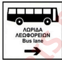
Προειδοποίηση ότι πλησιάζουμε συμβολή με λωρίδα αποκλειστικής κυκλοφορίας λεωφορείων στον κύριο δρόμο που έχει κατεύθυνση σύμφωνα με το βέλος
