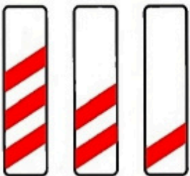
Αντίστροφη μέτρηση για μια ισόπεδη διάβαση (Κάθε γραμμή υποδηλώνει απόσταση 100μ μέχρι το σημείο κινδύνου)
